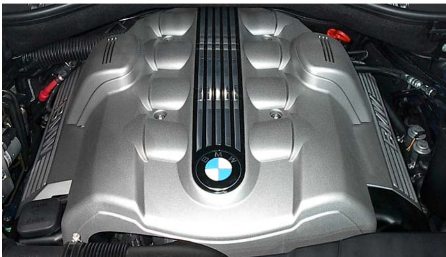
Bild 2: Achtzylindermotor der Fa. BMW mit Valvetronic und DoppelVanos
