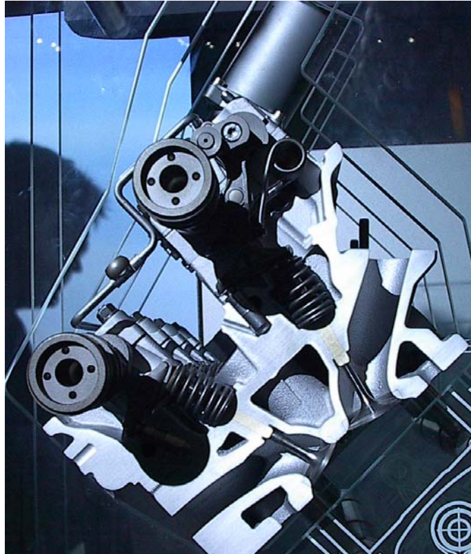
Bild 3: System Valvetronic der Fa. BMW an einem Schnittmodell
